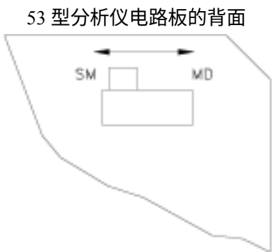
图3-2 单分析仪模式/多分析仪模式开关位置 (仅用于装备有 HART 的分析仪)
